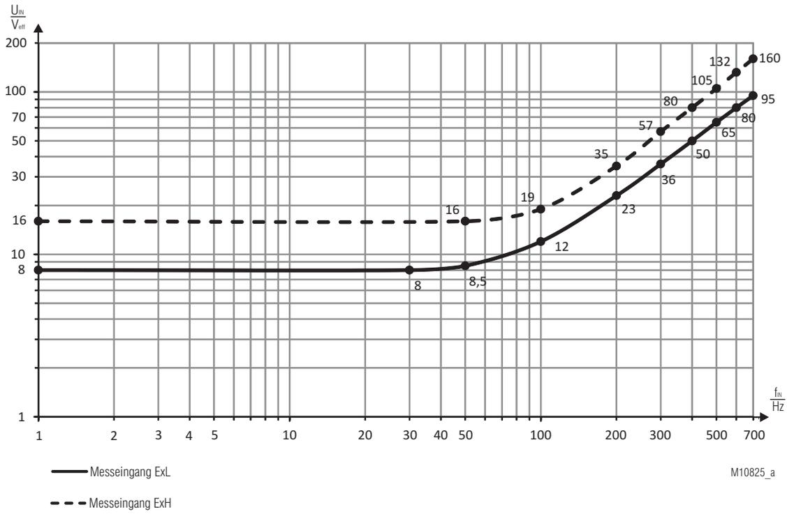
Mindestspannung am Messeingang für Variante /0\_ \_
