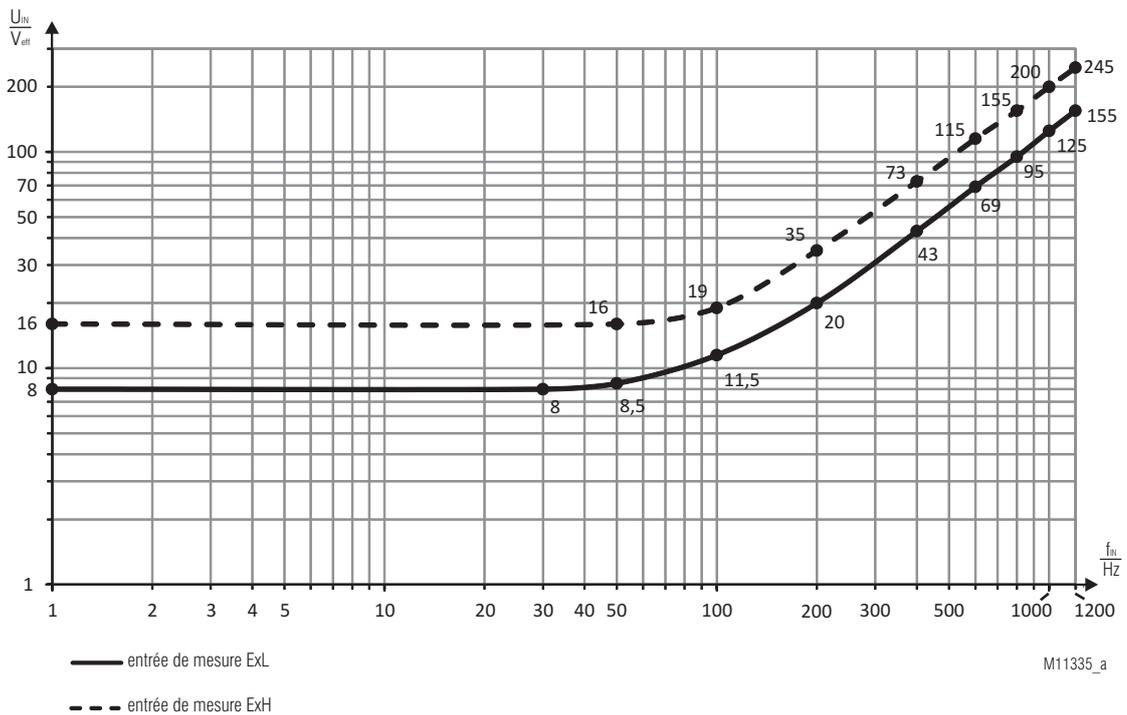
Tension minimale de entrée de mesure pour variante /1\_ \_
