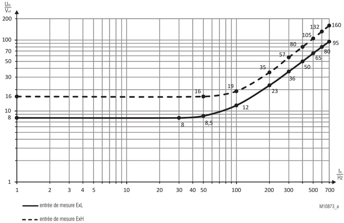
Tension minimale de entrée de mesure pour variante /0\_ \_
