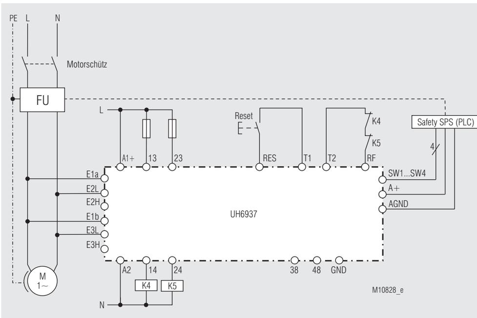
FU Überwachung, 1-phasig mit der Variante UH6937/\_1;
