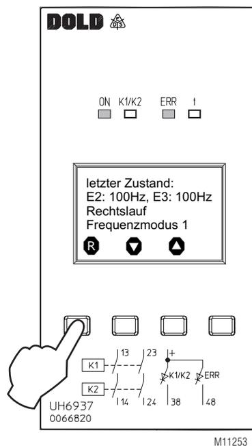
Wird ein Systemfehler nach dem Reset erneut erkannt, muss das Gerät an den Hersteller zurückgesendet werden.
