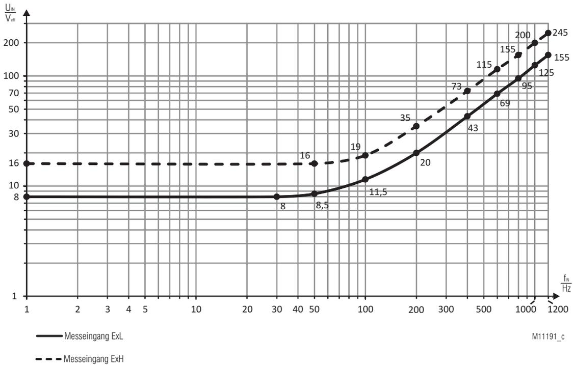
Mindestspannung am Messeingang für Variante /1\_ \_
